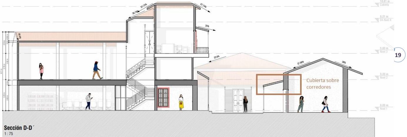
Imagen 24. Cubierta zona de corredores en la Casa de Cultura. Archivo personal.
